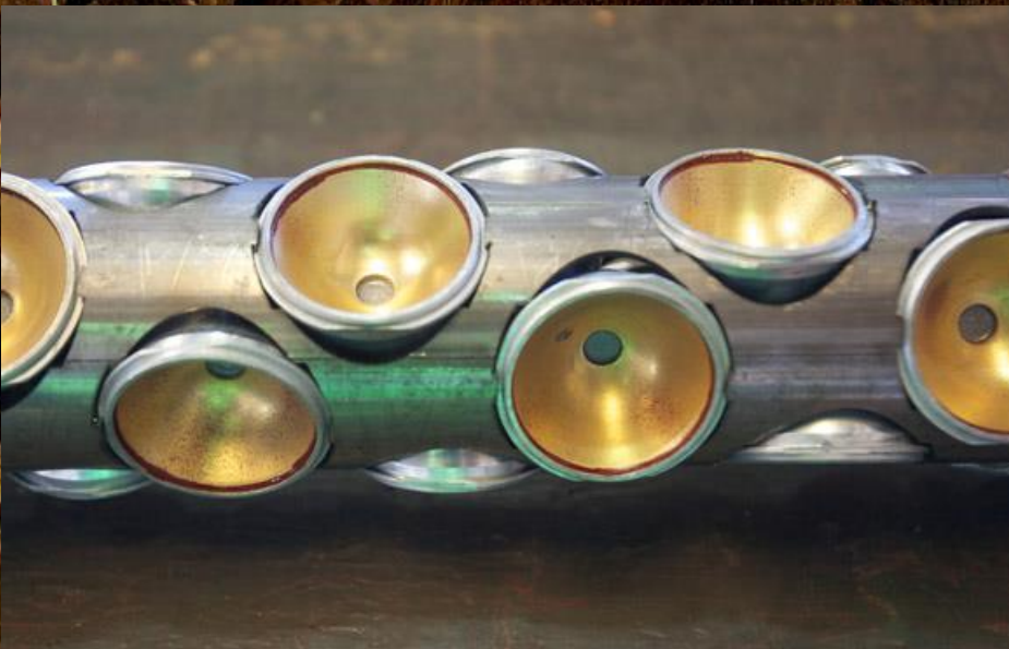
Rys. 3 - Widok fragmentu "działka" perforującego ściany odwiertu
