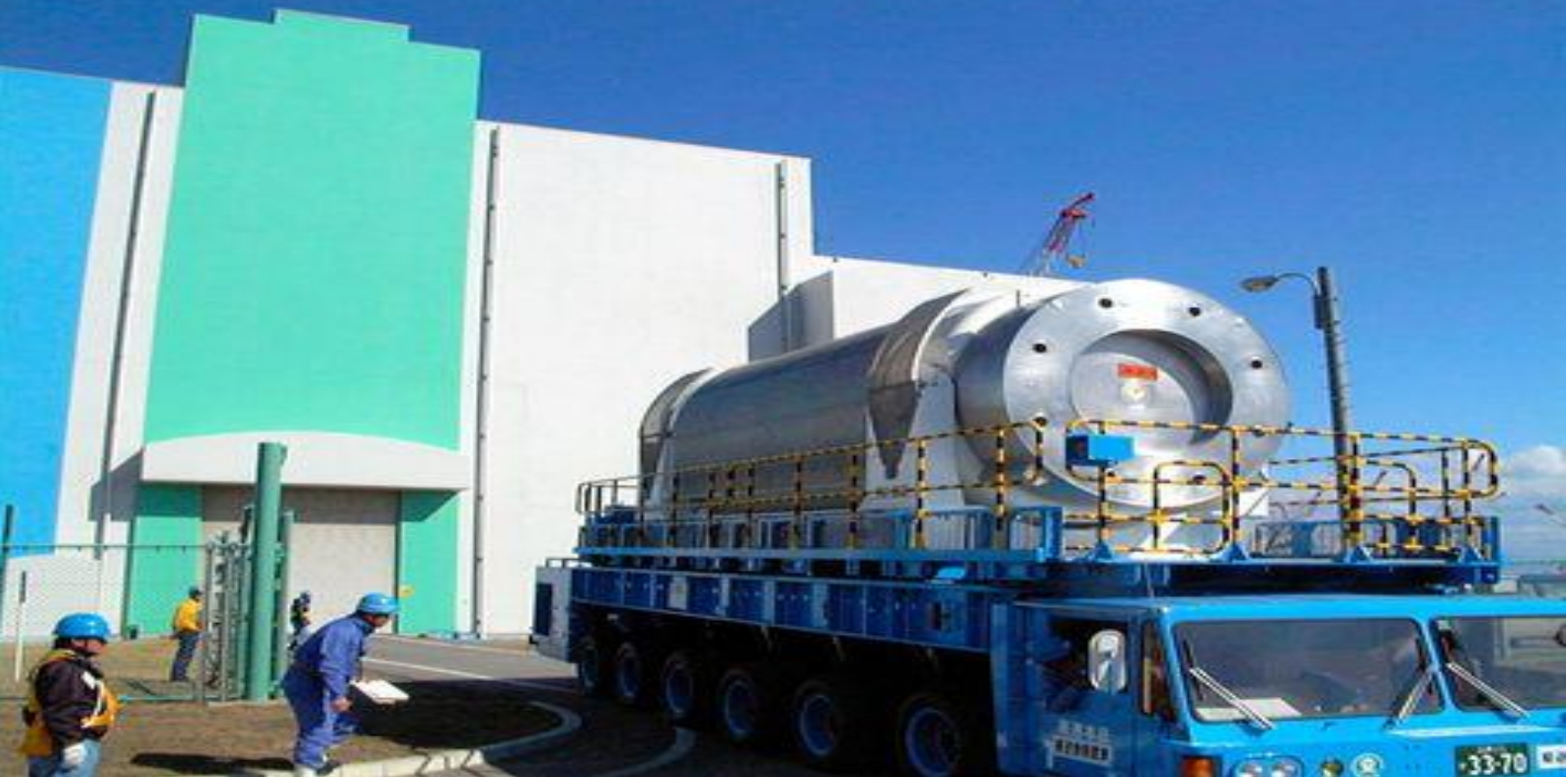
Rysunek 4. Przywóz wypalonego paliwa w konteinerze do zakładów Rokkasho Japonia (JNFL)
