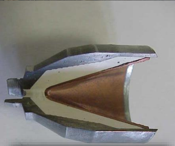
Rys. 1 - Widok naboju kumulacyjnego działka perforującego skałę w odwiertach łupkowych
