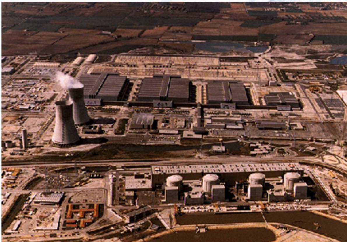
Rys.7. Należące do koncernu EdF zakłady wzbogacania uranu metodą dyfuzji gazowej w Tricastin we Francji.
