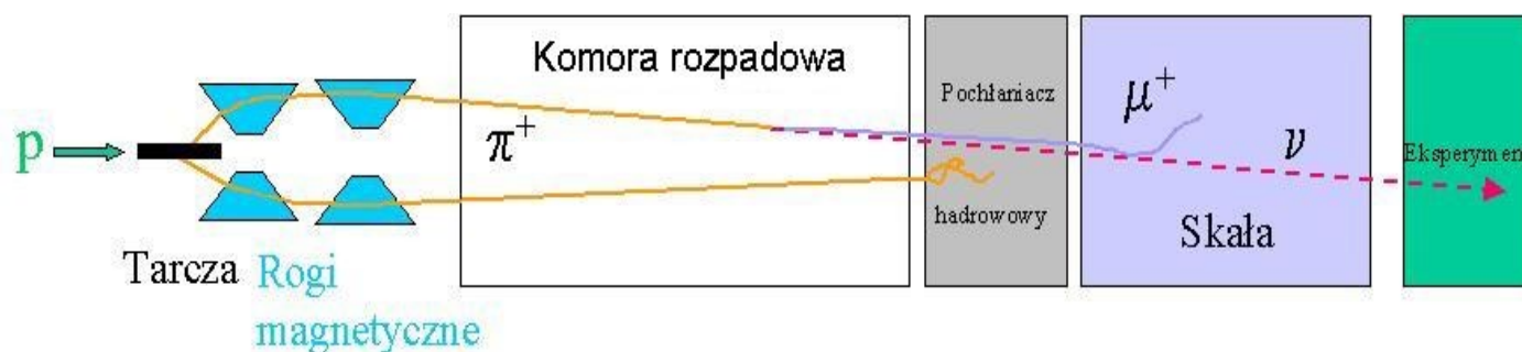
Rysunek 2. Schemat powstawania wiązki neutrino z wiązki protonów akceleratorowych w eksperymencie MINOS. Na podstawie [1].
