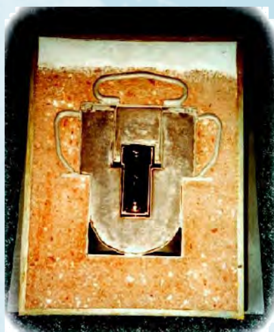
Rys. 3, 4. Przekrój przez pojemnik na wycofane z użytkowania zamknięte źródła radowe ( wygląd , schemat)
