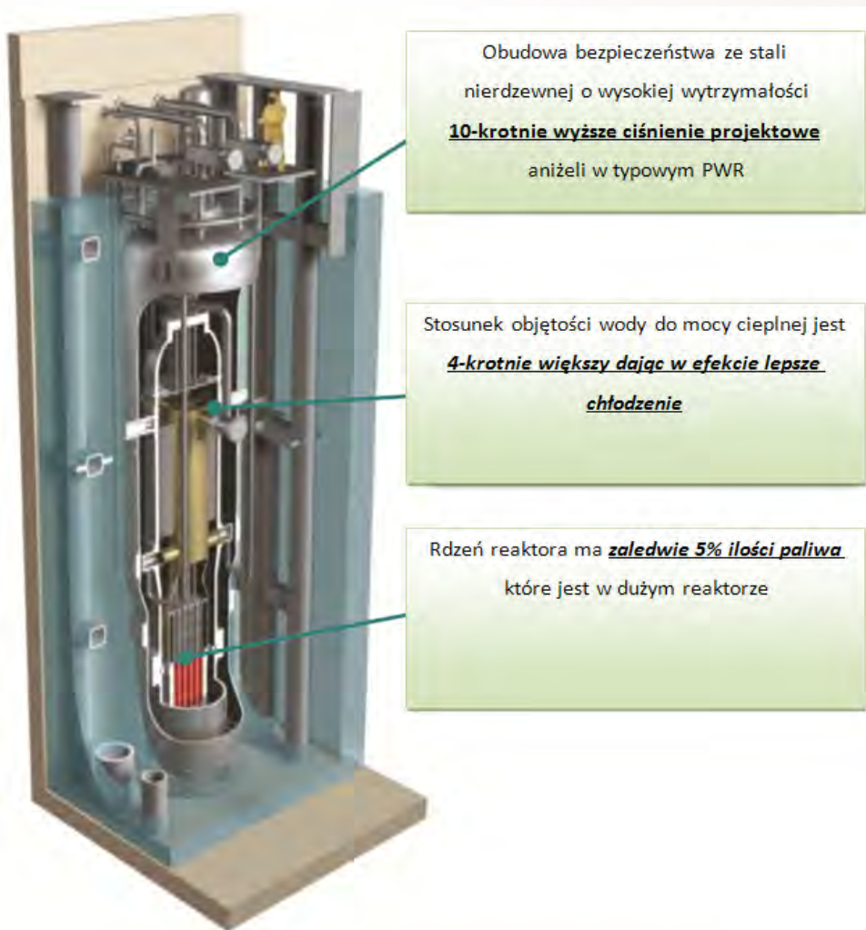
Rysunek 4. Obudowa bezpieczeństwa i zbiornik reaktora NuScale posiadają cechy, które w sposób naturalny zwiększają bezpieczeństwo
