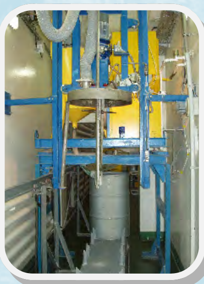
Rys. 7, 8. Instalacja do cementowania szlamów postrąceniowych i koncentratów powyparnych
