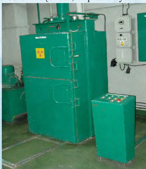
Rys. 1 i 2. Prasa hydrauliczna wykorzystywana do prasowania odpadów stałych
