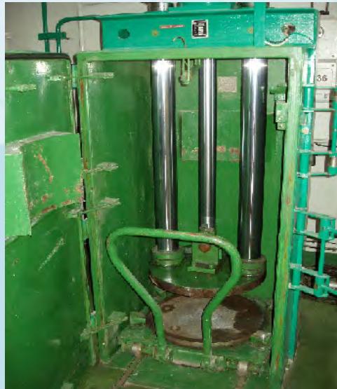
Rys. 1 i 2. Prasa hydrauliczna wykorzystywana do prasowania odpadów stałych
