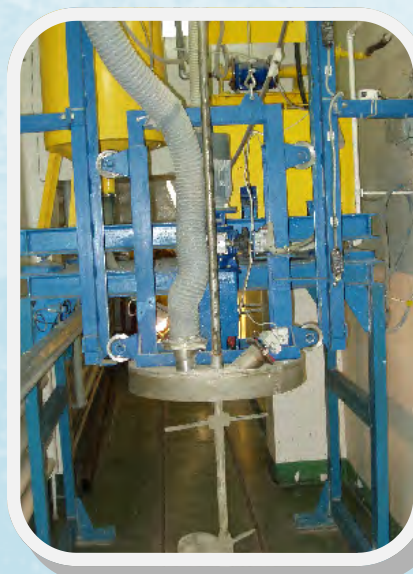
Rys. 7, 8. Instalacja do cementowania szlamów postrąceniowych i koncentratów powyparnych
