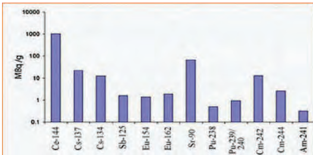
Rys. 5. Aktywność i skład izotopowy korium zalegającego pod gruzami czarnobylskiego reaktora na dzień 02.08.2006 1
