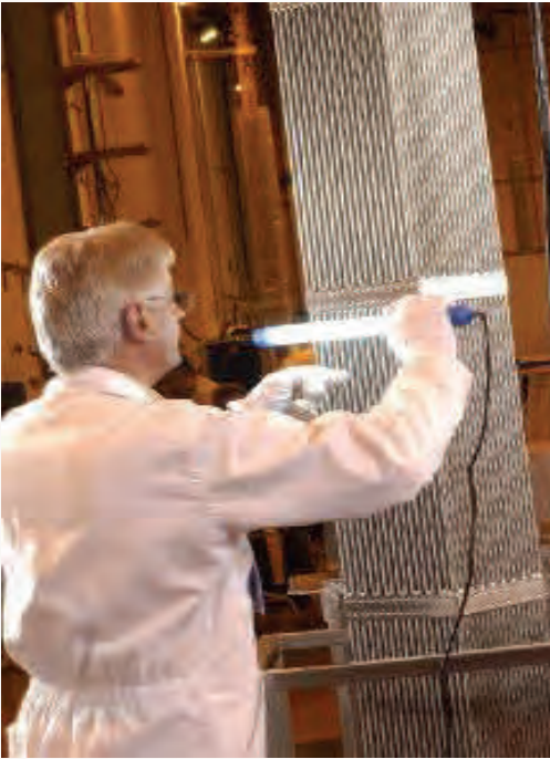
Kontrola prętów paliwowych ( www.aveva.com )
