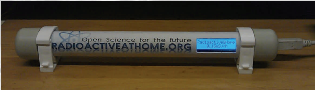
Rysunek 4 Alternatywny czujnik wykonany przez wolontariusza.
