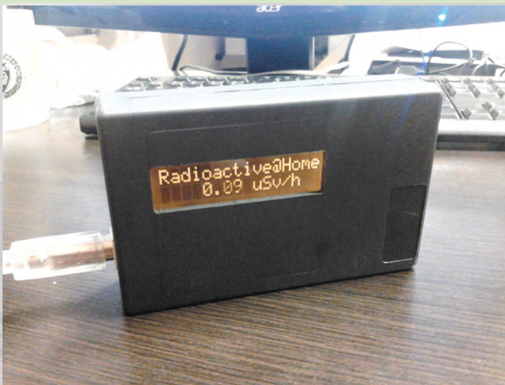
Rysunek 3 Czujnik podłączony do komputera i wyświetlający aktualny poziom promieniowania.
