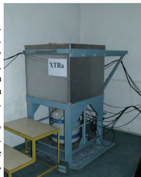
Rys. 5. Germanowy detektor półprzewodnikowy HPGe umieszczony w ołowianym domku osłonowym
