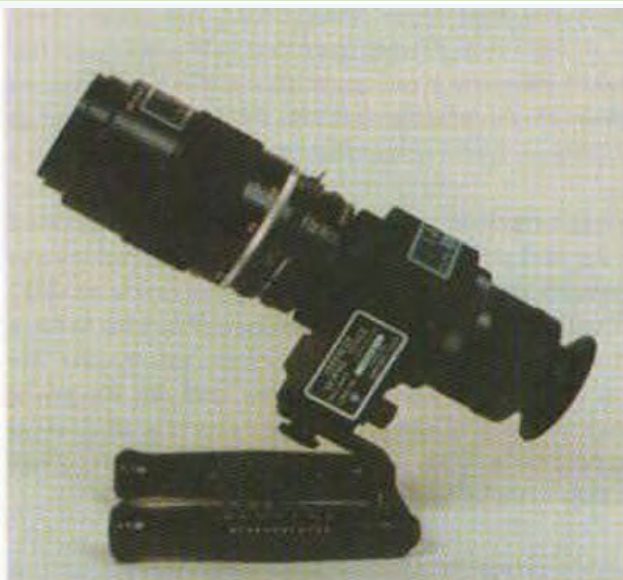
Rys. 7 Urządzenie do obserwacji promieniowania Czerenkowa w basenie wypalonego paliwa pozwalające na ocenę czy przechowywane w basenie kasety zawierają wypalone paliwo. Ze względu na długi czas przechowywania paliwa w basenie intensywność promieniowania Czerenkowa maleje i urządzenie to jest łączone z rejestratorem komputerowym pozwalającym potwierdzić istnienie promieniowania Czerenkowa widoczne po dokonaniu serii zdjęć wybranej kasety paliwowej. Urządzenie (ICVD Improved Cerenkov Viewing Device) jest używane w czasie każdej rutynowej inspekcji.
