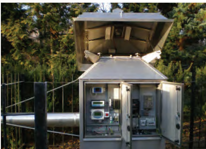
Rys. 2. Nowy model stacji ASS-500 (stacja NASS-500 – New Aerosol Sampling Station)
