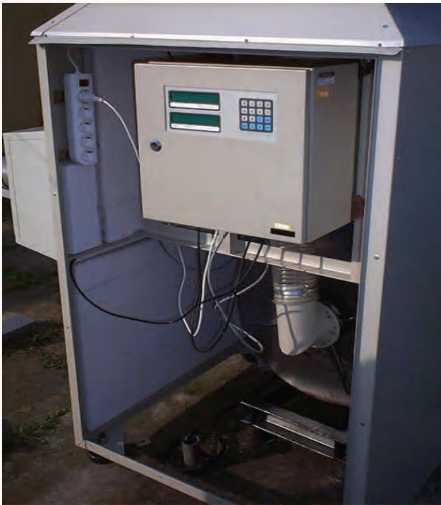
Rys. 4. Sterownik AS-01 obsługujący sondę scyntylicyjną – sterownik umieszczony jest w stacji ASS-500 (element systemu on-line)
