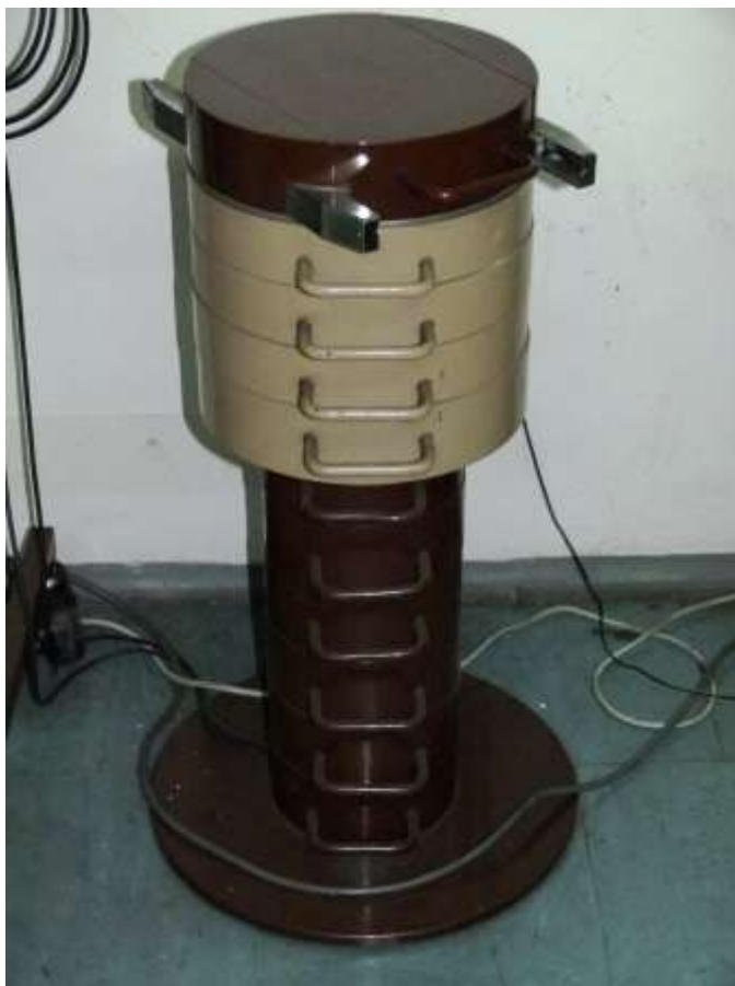
Rysunek 3. Domek osłonny (wykonany z ołowiu) do pomiarów surowców odpadowych
