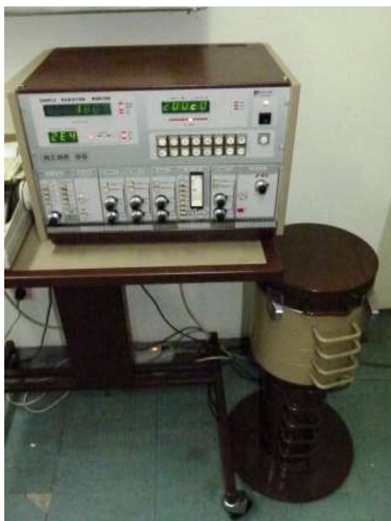
Rysunek 1 Aparatura pomiarowa do pomiarów surowców odpadowych – analizator trójkanałowy azar-90 oraz domek osłonny.
