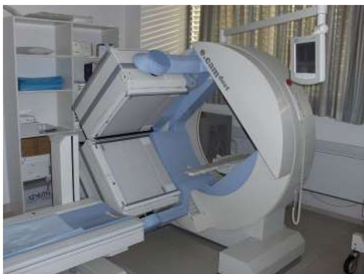
Rys. 4 - Nowoczesna gammakamera z dwoma głowicami (Siemens)
