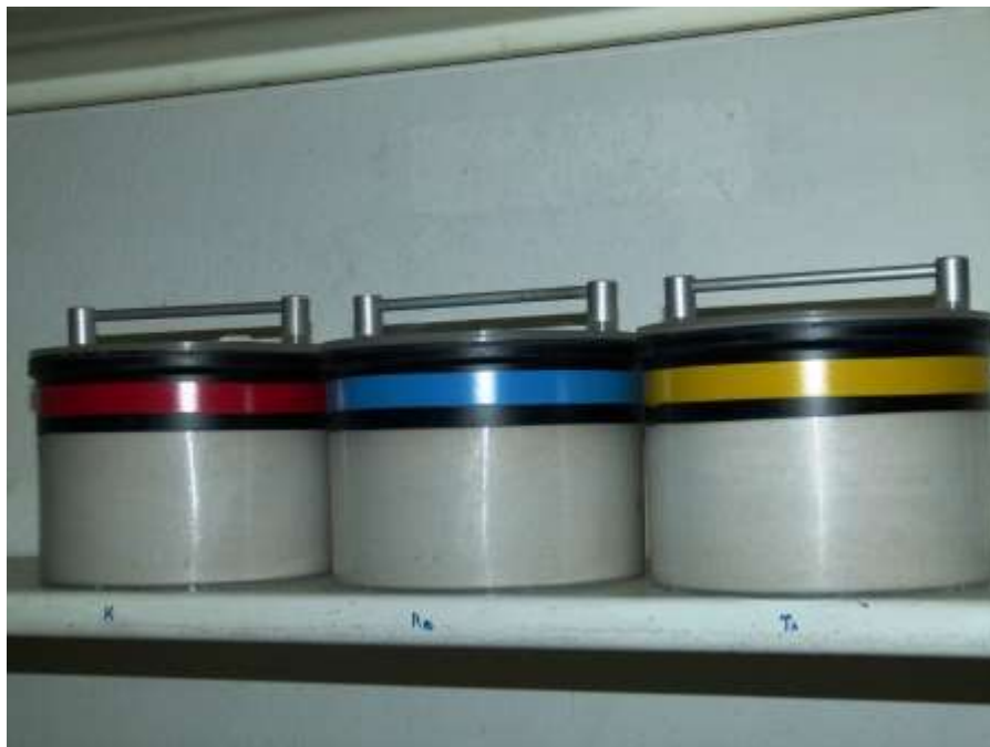
Rysunek 2 Zestaw wzorców kalibracyjnych (potas-40, rad-226, tor-228) do kalibracji aparatury pomiarowej.
