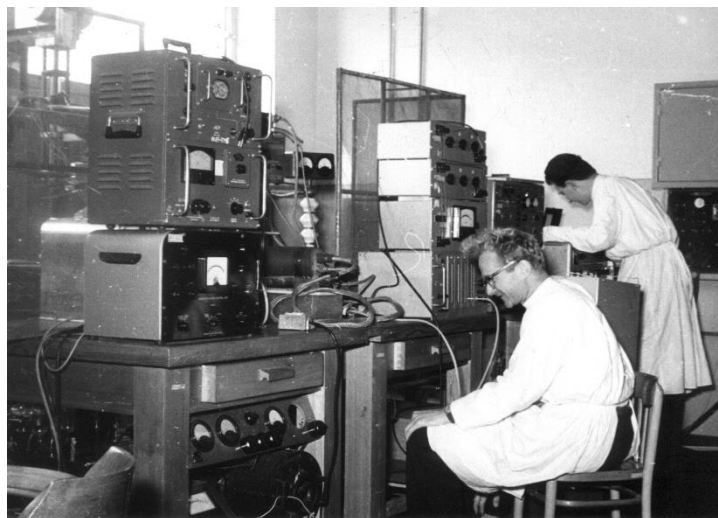
Rys. 10. Fotografia pierwszego układu do badań gorącej plazmy w Świerku w 1996 r. Komora próżniowa była umieszczona za zestawem aparatury pomiarowej.
