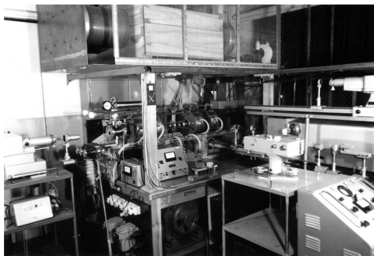
Rys. 11. Fotografia drugiego układu plazmowego (N-65) w Świerku, który wyposażono w działo typu RPI, silne elektromagnesy i nową aparaturę pomiarową.
