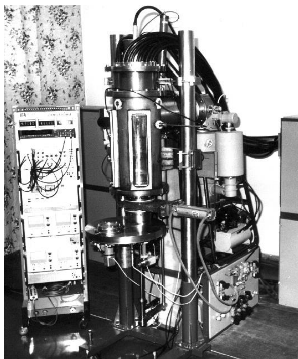
Rys. 20. Widok układu IONOTRON SW-30, który wyposażono w działo typu RPI (o osi pionowej) oraz poruszaną pneumatycznie tarczę do wymiany próbek. W głębi widoczne są urządzenia do zasilania i sterowania całego układu.
