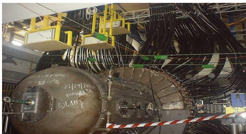
Rys. 27. Widok komory wielkiego układu PF-1000, zaprojektowanego przez badaczy z IPJ w Świerku, a zbudowanego i uruchomionego w IFPiLM w Warszawie (2000 r.)
