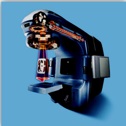
Rys. 6 - Schemat budowy głowicy liniowego akceleratora dla potrzeb radioterapii
