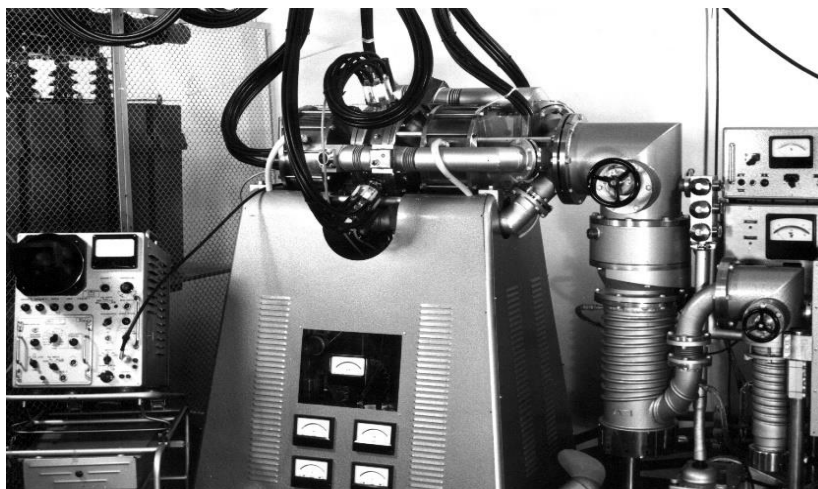
Rys. 16. Widok układu KAKTUS, w którym gorącą plazmę wytwarzało 6 małych iniektorów koaksjalnych, rozmieszczonych symetrycznie wokół centrum pułapki. Dodatkowo zastosowano 2 silne cewki, umieszczone po obu stronach pułapki [31].
