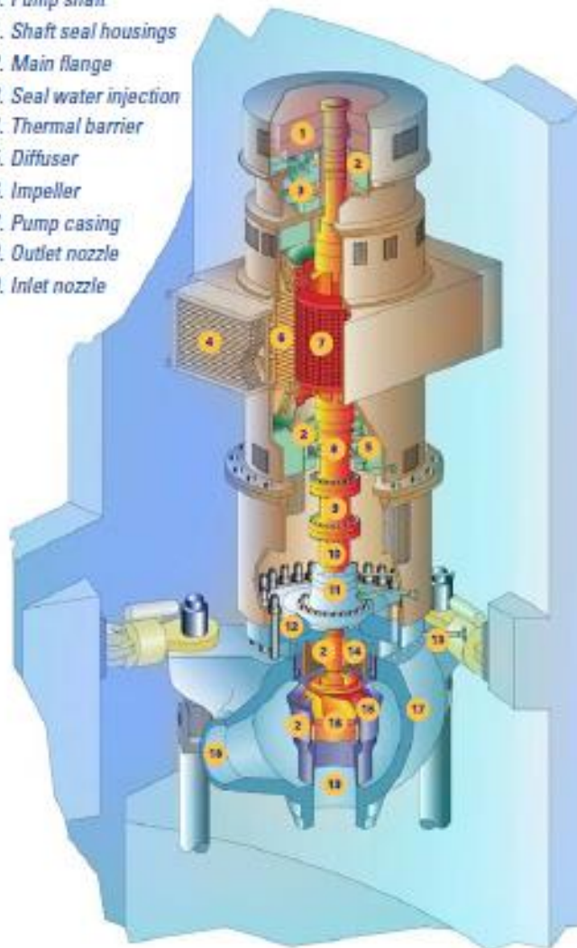
Rys. 12. Pompa główna układu chłodzenia reaktora EPRTM [1].
