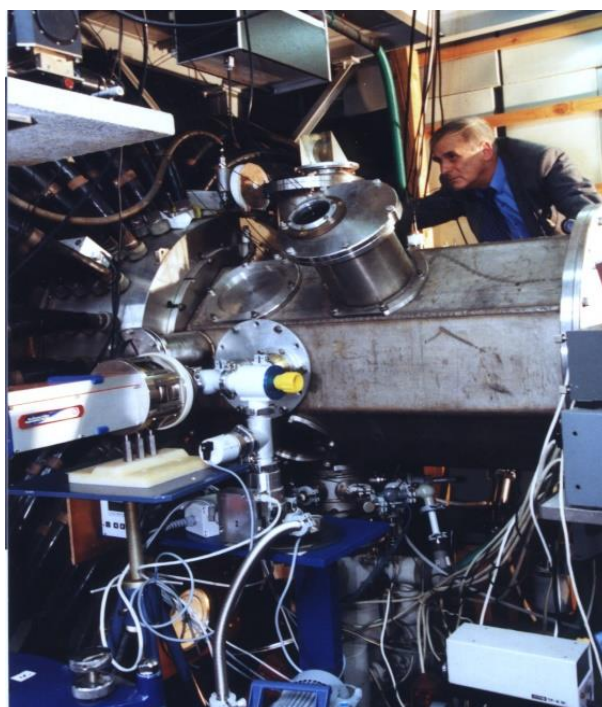
Rys. 24. Widok komory eksperymentalnej układu PF-360 i części wyposażenia pomiarowego. Po lewej stronie widoczna kamera do ultraszybkiej fotografii. U góry – kamera do zdjęć rentgenowskich i aktywacyjny licznik szybkich neutronów
