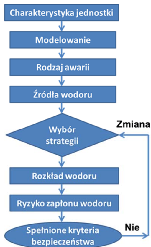
Rys. 12. Schemat postępowania przy analizie ryzyka
