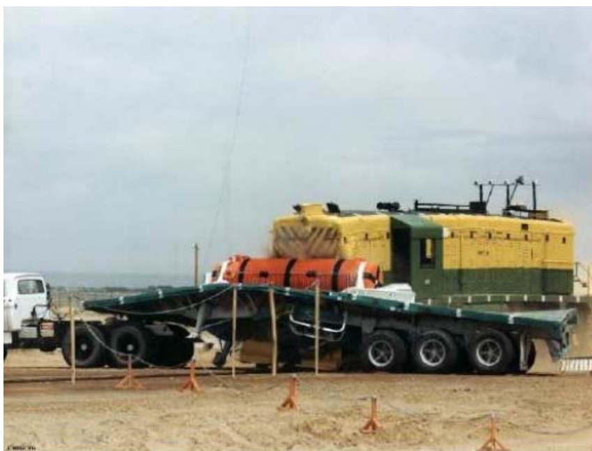
Ryc. 3 Test na odporność przechowalnika suchego na zderzenie z lokomotywą
