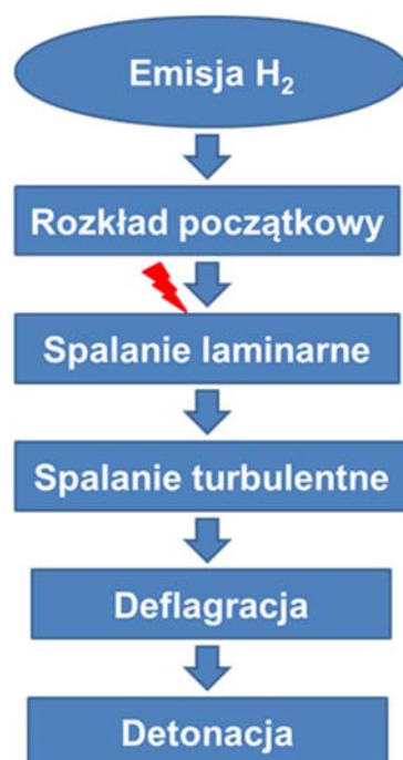
Rys. 4. Prawdopodobna sekwencja zdarzeń przy spalaniu wodoru
