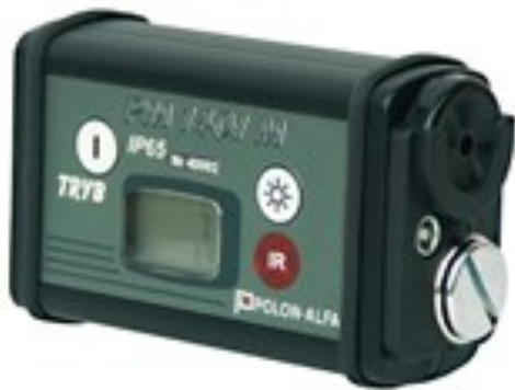
Rys.5 – Przykład zastosowania scyntylatora CsJ/Tl – monitor promieniowania gamma PM-1401M
