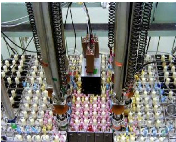
Rysunek 9 Rdzeń A (podobnie zbudowany jest rdzeń B) zestaw krytyczny KUCA
