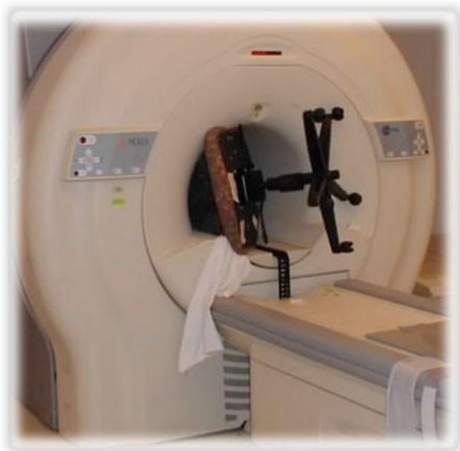
Rys. 11 - Fotel biurowy wciągnięty w głąb tomografu siłą pola magnetycznego
