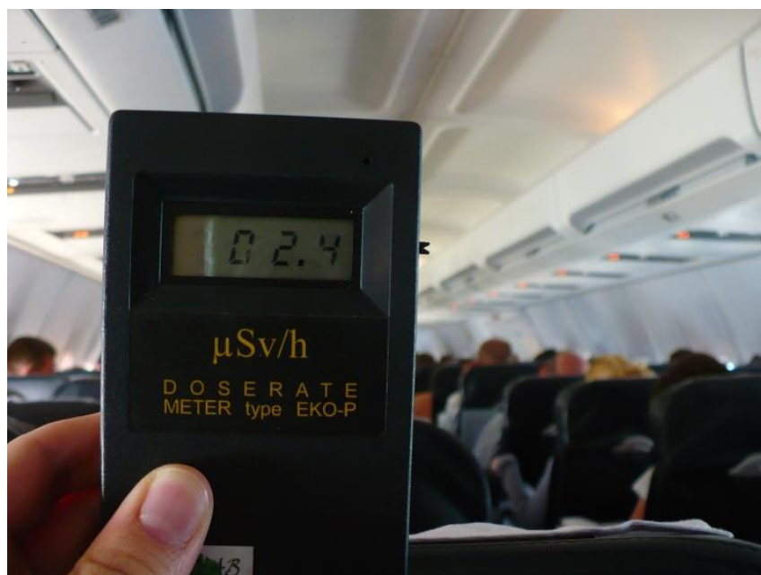
Rys. Dozymetr pokazujący moc dawki promieniowania gamma równą 2,4 \mu\text{Sv/h} (w odniesieniu do dawki skutecznej); zdjęcie wykonano na pokładzie samolotu pasażerskiego, 11 km nad ziemią; po wylądowaniu moc dawki spadła do ok. 0,15 \mu\text{Sv/h} (15 razy), czyli do naturalnego poziomu promieniowania na ziemi [fotografia własna autora]
