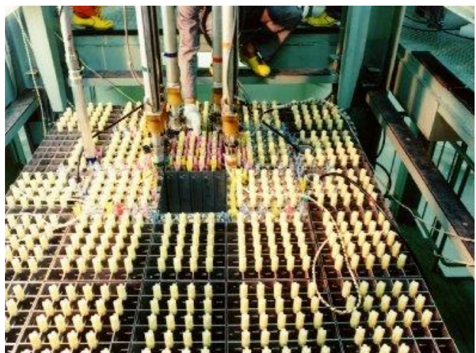
Rysunek 9 Rdzeń A (podobnie zbudowany jest rdzeń B) zestaw krytyczny KUCA
