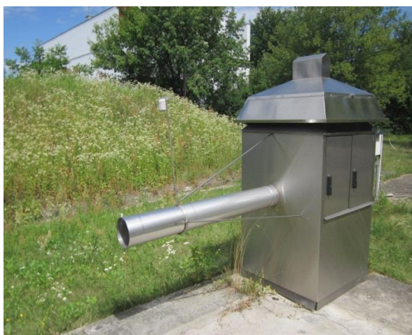
Rys. 2. Nowy model stacji ASS-500 (stacja NASS-500 – New Aerosol Sampling Station).
