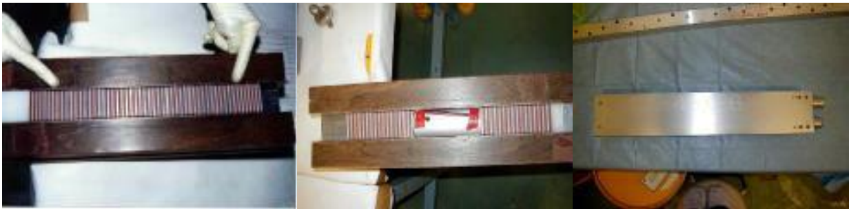
Rysunek 7 Paliwo wykorzystywane w rdzeniach zestawu KUCA
