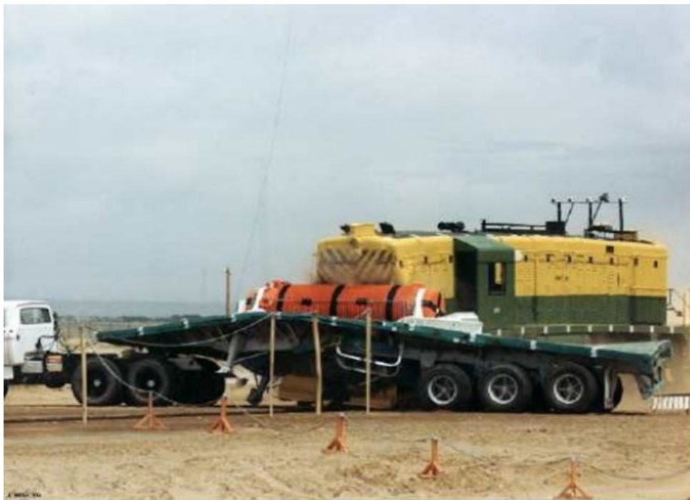
Ryc. 3 Test na odporność przechowalnika suchego na zderzenie z lokomotywą (źródło: http://www.sandia.gov/recordsmgmt/ctbm1.html - dostępne 9 maja 2014 r.)
